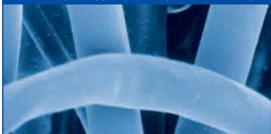
Обычный фильтрующий материал (Ув. в 600 раз)
